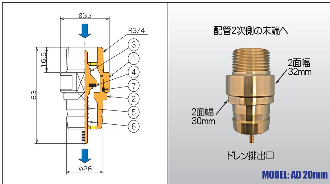
注：対象とする配管2次側の末端より本弁排出口が低い位置になる様に設置してください
